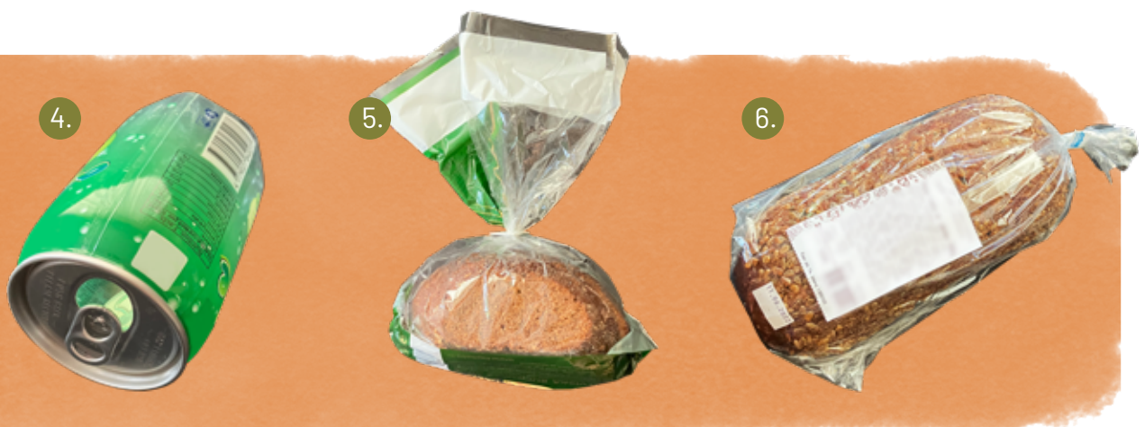
4. bilde – alumīnijs daļēji aizstāts ar PET – mazāks ekoloģiskās pēdas nospiedums ražošanas posmā, tomēr no pārstrādes viedokļa neveiksmīgs risinājums, jo materiālus grūti atdalīt.
